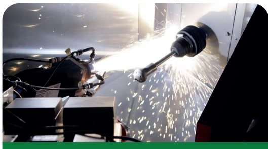
Revêtement d'un implant par projection APS robotisée
