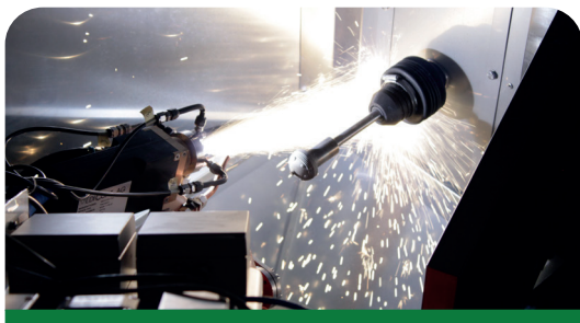
Revêtement d'un implant par projection APS robotisée
