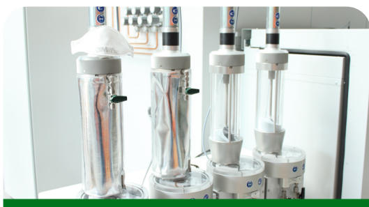
Distributeur de poudre à plateau tournant
