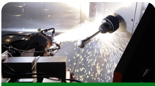
Revêtement d'un implant par projection APS robotisée
