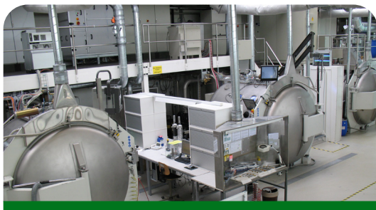
Machines de production des revêtements VPS
