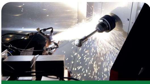
Revêtement d'un implant par projection APS robotisée
