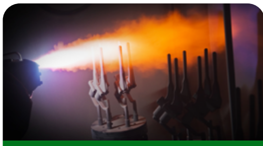
Prothèses en cours de revêtement par Projection Plasma Sous Vide
