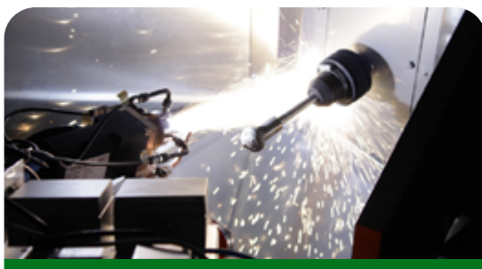
Revêtement d'un implant par projection APS robotisée
