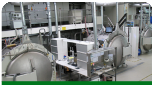
Machines de production des revêtements VPS
