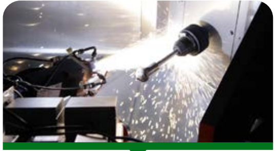
Revêtement d'un implant par projection APS robotisée
