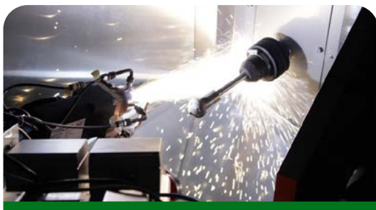
Revêtement d'un implant par projection APS robotisée
