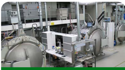
Machines de production des revêtements VPS
